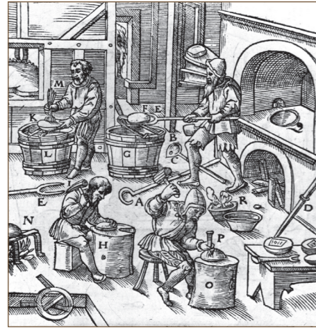
Le minerai était concassé, fondu dans un four ou un fourneau muni de soufflets, puis martelé et refondu avant d'être éventuellement allié à un autre métal, comme le cuivre et l'étain pour produire du bronze.
