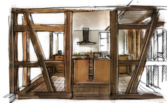
Le colombage ajouré offre des espaces ouverts et lumineux tout en conservant la structure porteuse du bâtiment.
