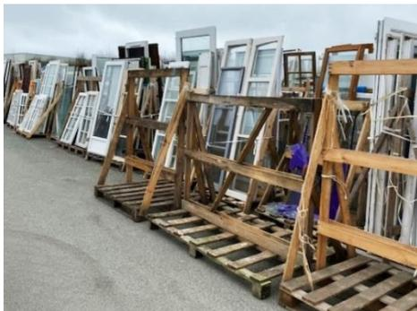
Figure 46 : Collecte en rack d'huisseries intègres en vue de leur démantèlement en atelier – Source : Recovering
