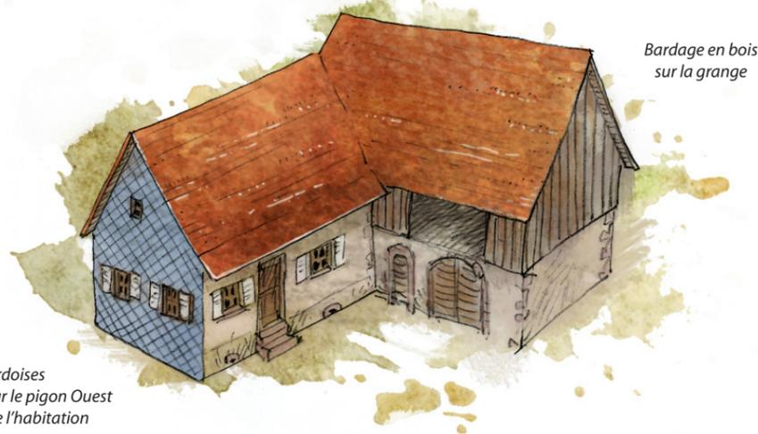
Les bardages utilisés pour la protection des façades exposées aux vents dominants et aux intempéries, le plus souvent sur les pignons orientés à l'Ouest, sont apparus plus tardivement que les bardages des granges. Dans ce cas, les matériaux rencontrés sont plutôt l'ardoise, les plaques de tôle, ou les plaques d'amiante ciment.
