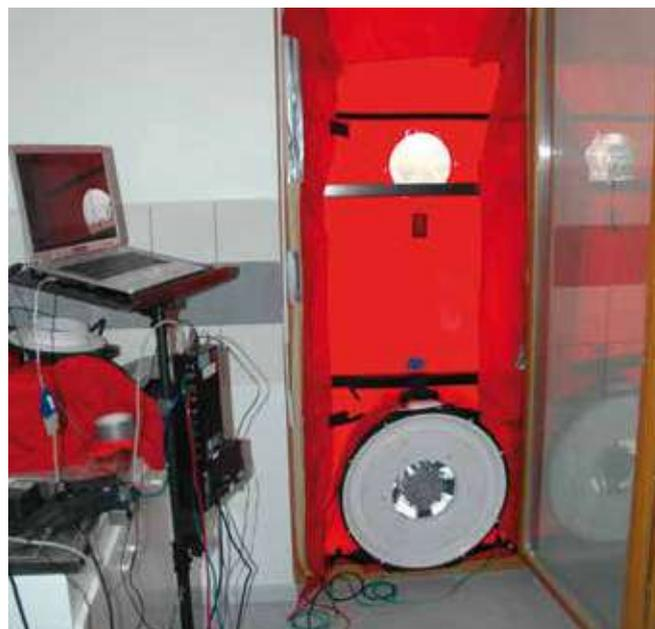
Test d'étanchéité à l'air à découvrir en vidéo sur <https://www.dailymotion.com/video/xmtkij>
